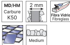
**Corte profundo en materiales muy abrasivos como la fibra de vidrio. Filos de corte redondeados para evitar sacudidas y conseguir una profundización suave del corte.**
